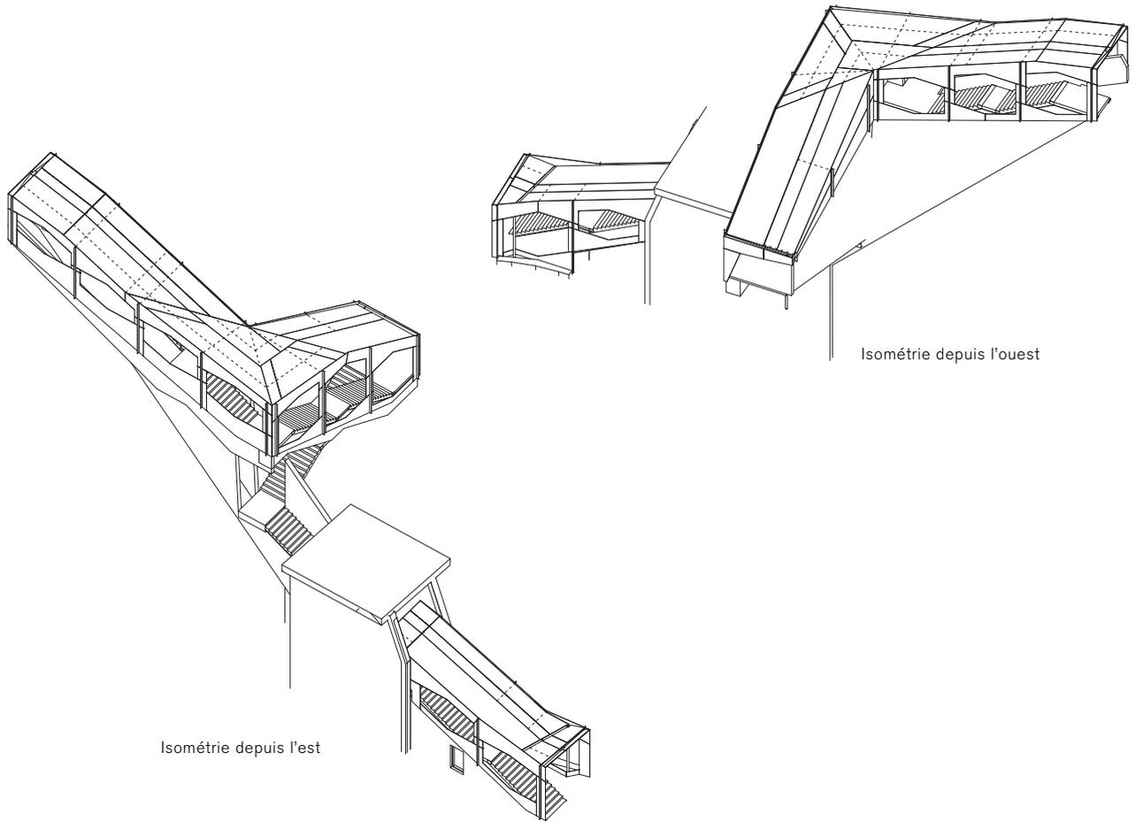
Les nervures verticales disposées entre les éléments de paroi renforcent la mince structure de l'enveloppe.
