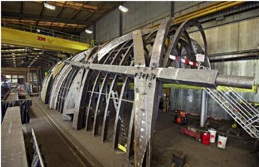
Zur Überprüfung der Passgenauigkeit wurden die einzelnen Stahlelemente bereits im Werk vormontiert.
