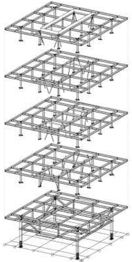
Isometrie der Stahlkonstruktion Ebene +4 Verwaltung Ebene +3 Verwaltung Ebene +2 Verwaltung und Konstruktion Ebene +1 Montage Kleingeräte Ebene 0 Montage Grossgeräte und Zwischengeschoss
