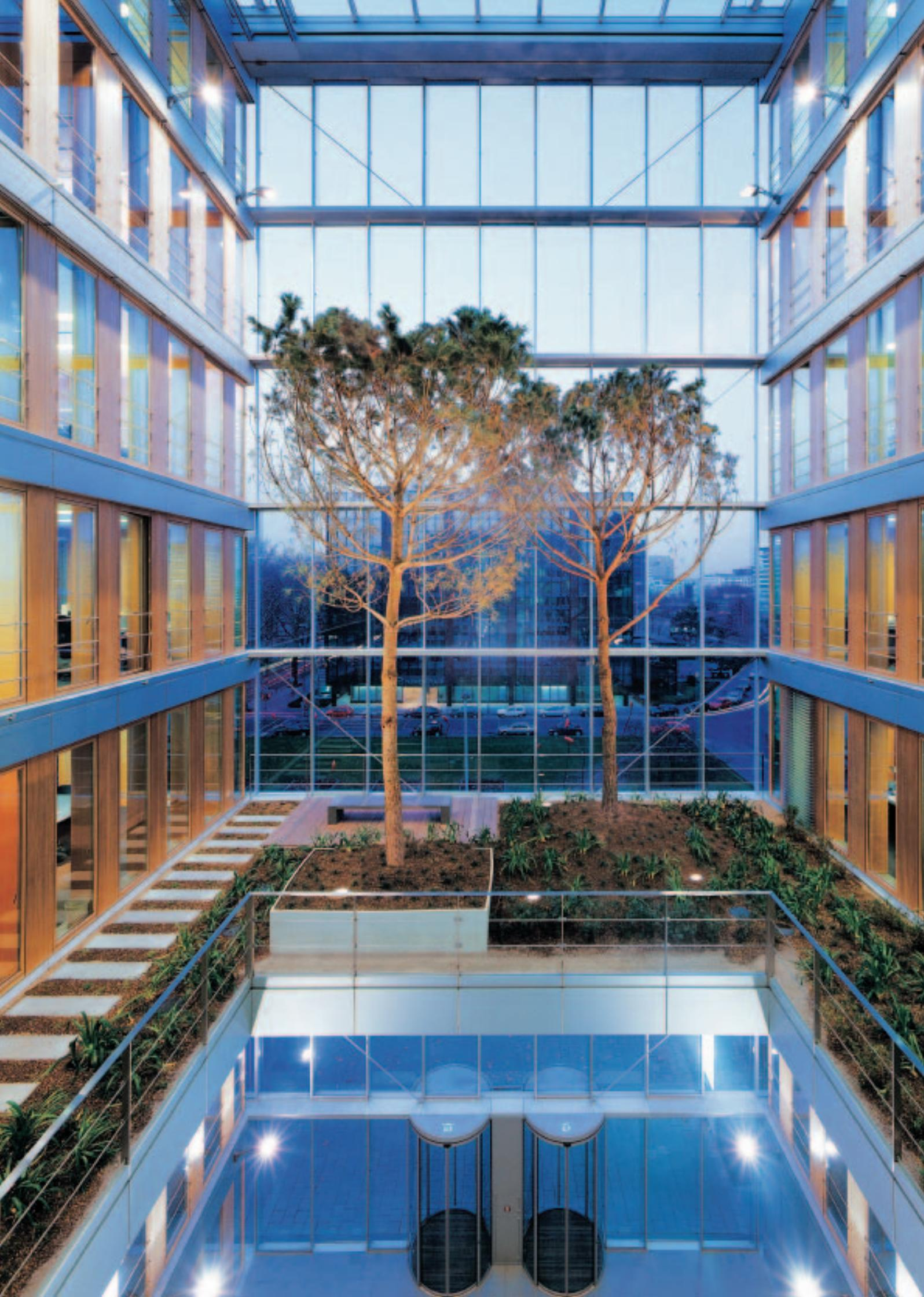
Atriumfassade zurück gesetzt, so dass ein überdeckter Aussenraum entsteht. In dem Atrium befindet sich ausserdem ein freistehender Aufzugsturm mit zwei Aufzügen.
