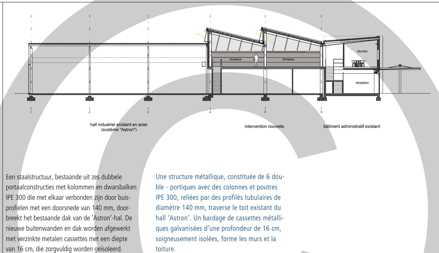
Een staalstructuur, bestaande uit zes dubbele portaalconstructies met kolommen en dwarsbalken IPE 300 die met elkaar verbonden zijn door buisprofielen met een doorsnede van 140 mm, doorbreekt het bestaande dak van de 'Astron'-hal. De nieuwe buitenwanden en dak worden afgewerkt met verzinkte metalen cassettes met een diepte van 16 cm, die zorgvuldig worden geïsoleerd.
