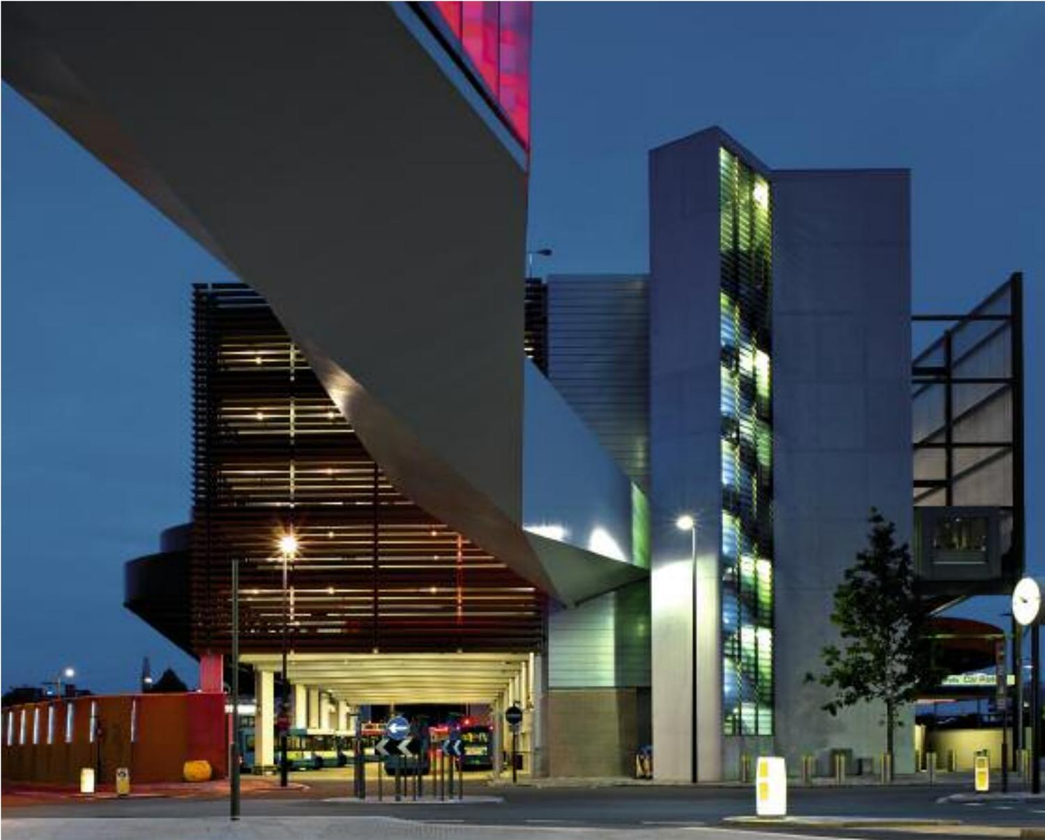
La forme coudée de la passerelle est due à la position décalée des points à relier.
