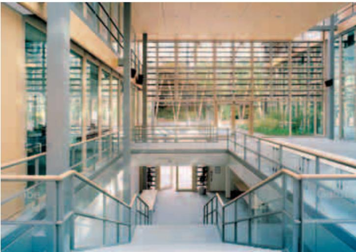
Die Stahlbauteile wurden durch Brandschutzanstriche geschützt, die Decken durch Holzwerkstoffplatten.
